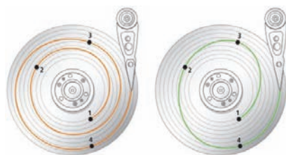
Postup zápisu/čtení bez technologie NCQ (vlevo) a s použitím NCQ (vpravo)
